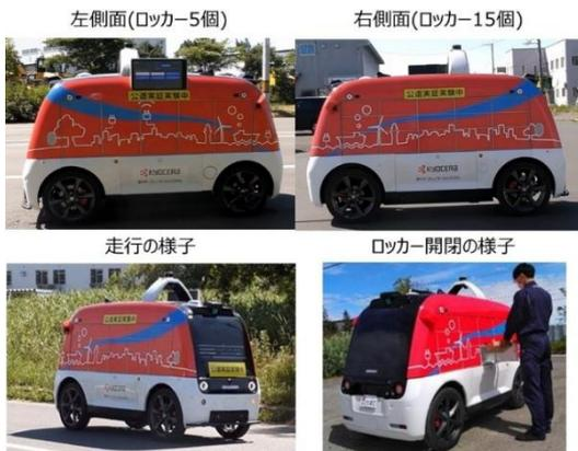
図1 車道走行する自動走行ロボット
